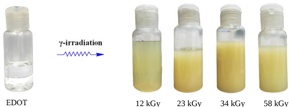
Hình 2 – Dung dịch nước bão hoà N_2 chứa 5 mM monomer EDOT và 0.2 M isopropanol trước chiếu xạ và sau chiếu xạ ở các liều 12 kGy, 23 kGy, 34 kGy và 58 kGy
